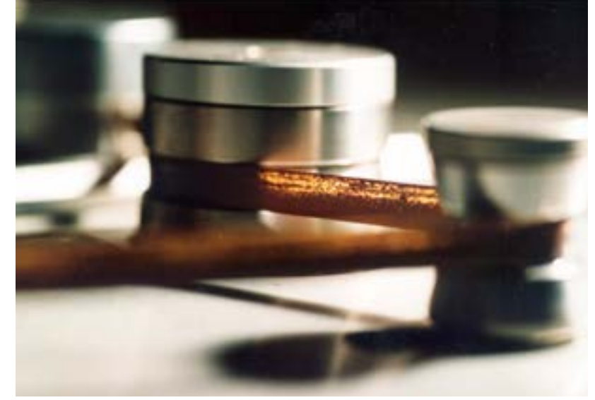
الشكل 13: تقشر الصبغة: تدهور كيميائي أم سوء صناعة؟
