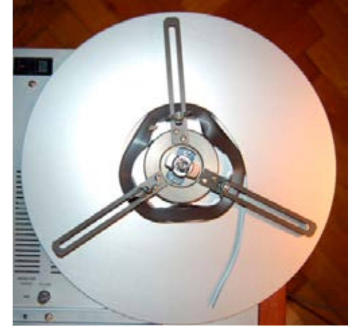
الشكل 24: الويكيلريتر- جهاز يساعد على إنقاذ الأشرطة إذا انزلقت محاورها.
