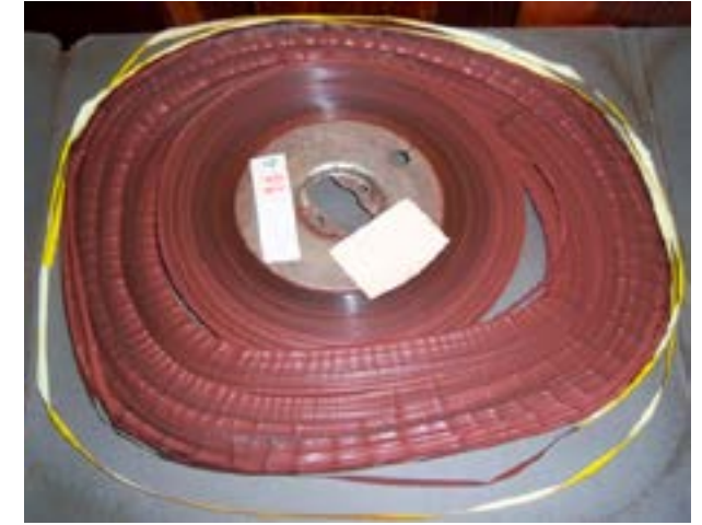
الشكل 11 و 12: حالة جفاف وتقصف مثالية لشريط مصنوع من خلاص السليلوز قبل وبعد إصلاحها (إعادة لفها حول بكره). يمكن إنقاذ الشريط الذي إنزلق عن مكانه بمساعدة جهاز Wickelretter (أنظر الفقرة 3-4-2 و 1-2-24 والشكل 24)
