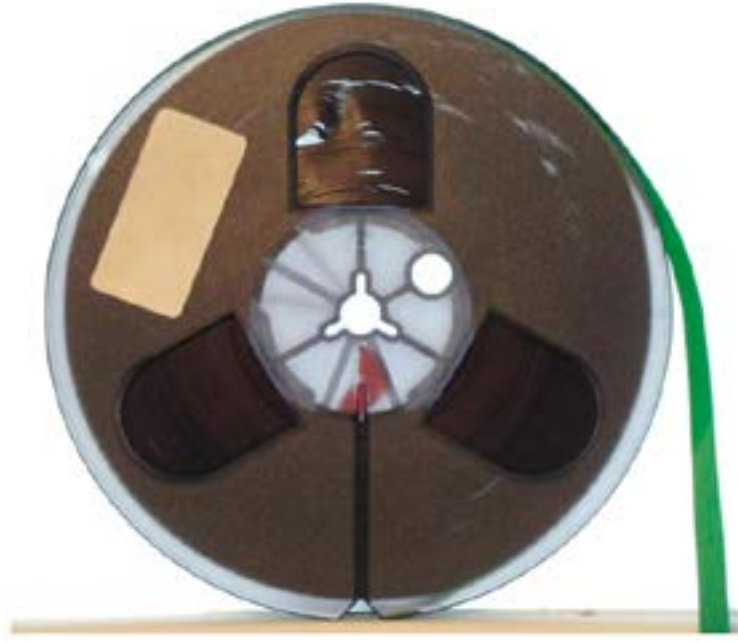
الشكل 23: "اللف اليدوي". قد يحتاج الأمر لتدخل يدوي لتحقيق إستقامة لفة الشريط دون إتلاف الشريط من خلال الإحتكاك بالشريط المنزلق.
