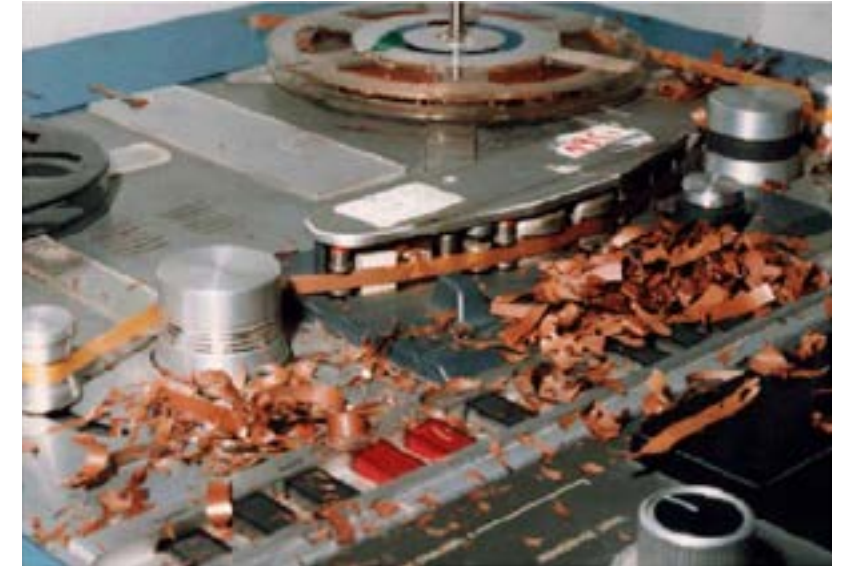
الشكل 14: حالة نادرة من خسارة تامة للصبغة. هذه الحالة على الأرجح بسبب مشكلة في عملية الإنتاج.
